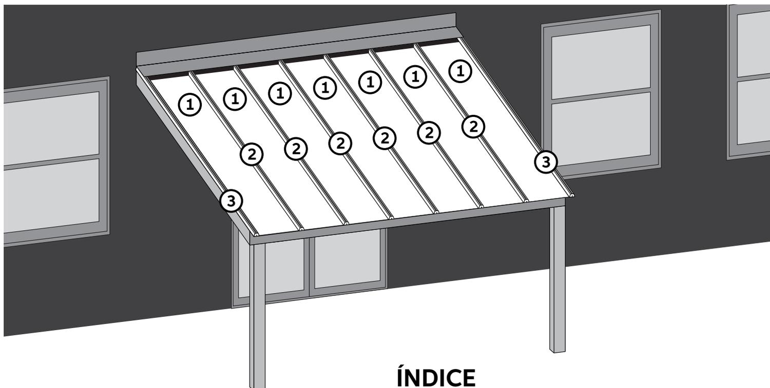
**SUNSCAPE® es un sistema de tres partes que se instala en una estructura de techo existente. Aquí le indicamos cómo calcular las cantidades necesarias de cada parte.**
